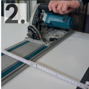
Im nächsten Schritt die Platten mit der Handkreissäge auf die Zielmaße zuschneiden. Für diesen Schritt empfehlen wir die Verwendung einer Handkreissäge mit Führungsschiene.
