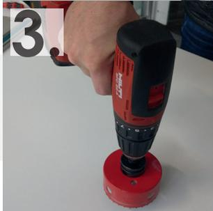
Mit passenden Lochsägenaufsätzen können nun Löcher für die Armaturen gebohrt werden.
